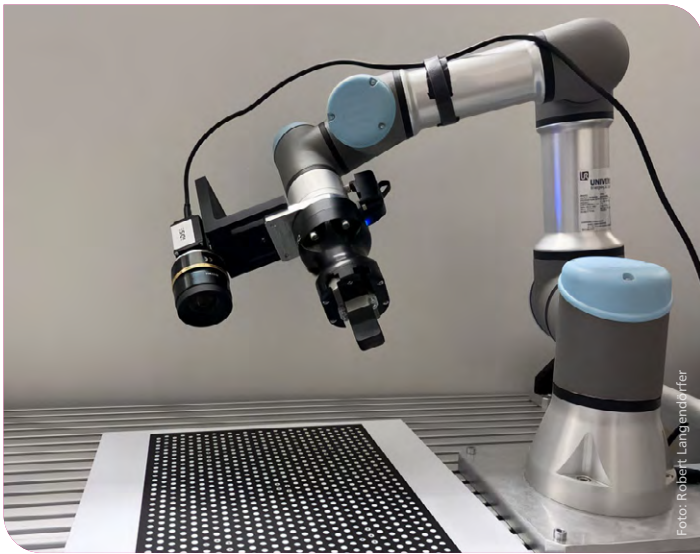
Roboterkalibrierung: Bildaufnahme des Kalibrierkörpers.
